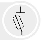
Ce déconnecteur peut être intégré dans le produit (SPDI suivant la norme NFC15-100), on parle alors de parafoudre auto-protégé. C'est le cas dans la plupart des parafoudres Type 2 ou 3 de conception récente et dans certains parafoudres de Type 1 également. **La plupart des parafoudres ADEE electronic intègrent le déconnecteur associé (auto-protégé).**
