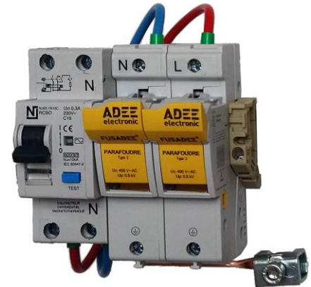
3XFRH180101: ensemble modulaire parafoudre monophasé à continuité de service pour sites peu exposés.
