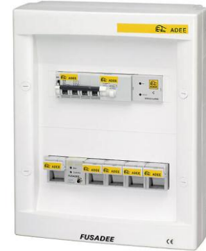
FUSTD15/22A : boîtier parafoudre tétrapolaire à continuité de service pour sites exposés avec déconnecteur associé et module d'alarme intégré et contrôleur de cartouches.
